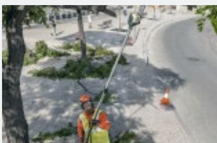
Der Akku-Hochentaster 536LiPT5 verfügt über einen Teleskopschaft mit einer Reichweite von bis zu 5,5 m.
